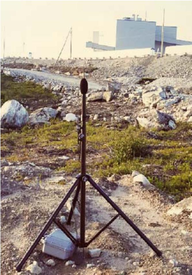
**Photo 3.14** Mesure des niveaux sonores sur une période de 24 h à l'aide d'un sonomètre
