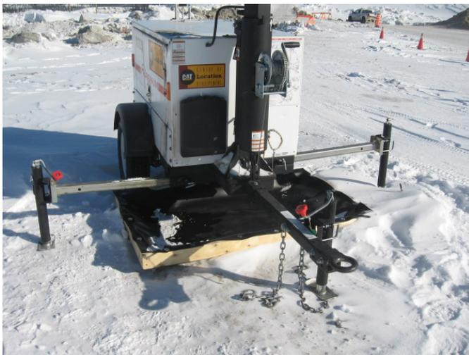
**Photo 3.5** Bac étanche positionné sous une tour d'éclairage
