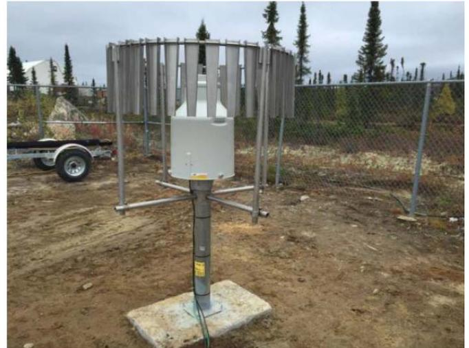
**Photo 3.10 Précipitomètre situé à proximité de la tour météorologique**
