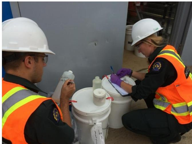
**Photo 5.2** Prise d'échantillon de l'effluent minier temporaire par les agents d'EC (août 2015)
