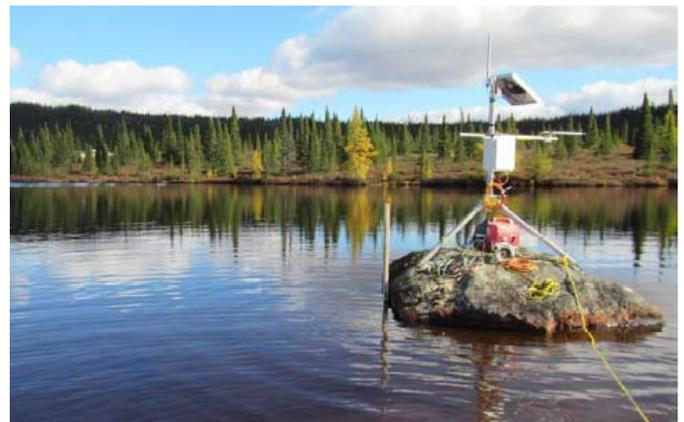
**Photo 3.16** Station limnimétrique sur le lac F3300
