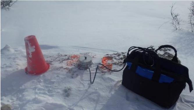
**Photo 3.15** Mesure des vibrations lors des activités de dynamitage à l'aide d'un sismographe
