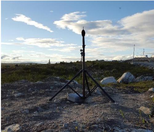
**Photo 3.5 Station d'enregistrement pour le suivi acoustique**
