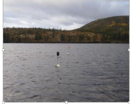
**Photo 3.7** Dériveur utilisé pour mesurer la vitesse du courant
