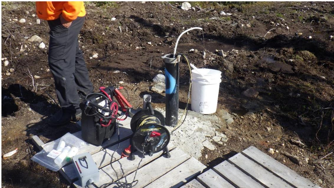
Photo 3.49 Procédure de rinçage d'un puit (juillet 2017)
