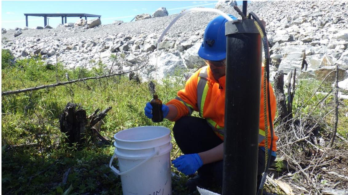
Photo 3.48 Échantillonnage d'eau souterraine (juillet 2017)
