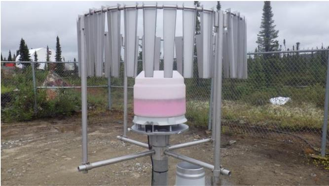
**Photo 3.2 Pluviomètre situé à proximité de la tour météorologique**
