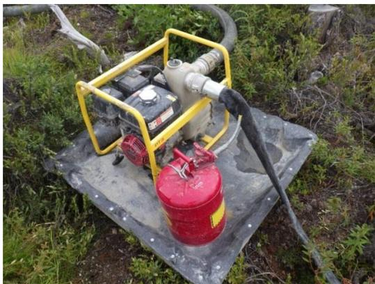
**Photo 2.1** Bac de rétention sous une pompe à eau
