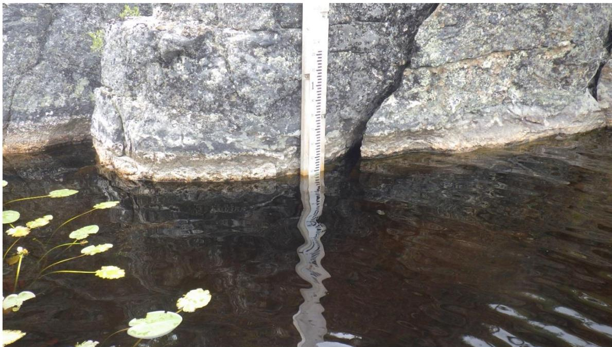
Photo 3.15 Règle servant à mesurer le niveau de l'eau dans le lac F3298
