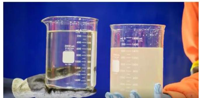
Photo 3.42 Turbidité à l'effluent (bêcher de gauche) comparée à celle de l'affluent (bêcher de droite)
